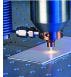
使用等离子聚合工艺 进行表面涂层处理
